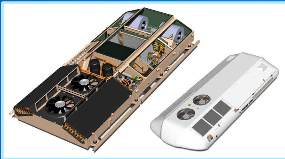
Klimatizační jednotka pro kolejová vozidla - LRV Návrh rámu, rozmístění komponentů, finální tvar kapoty
