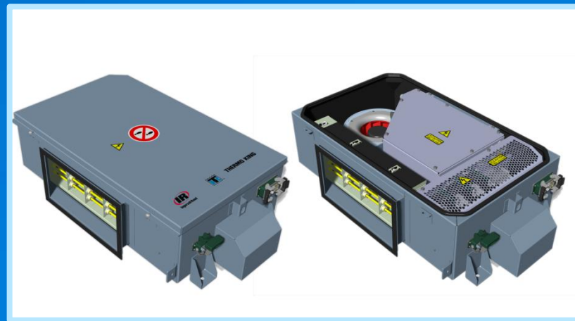
Klimatizační jednotky – Thermo King Vývoj rámu, elektroinstalací, chladicího okruhu, izolací
