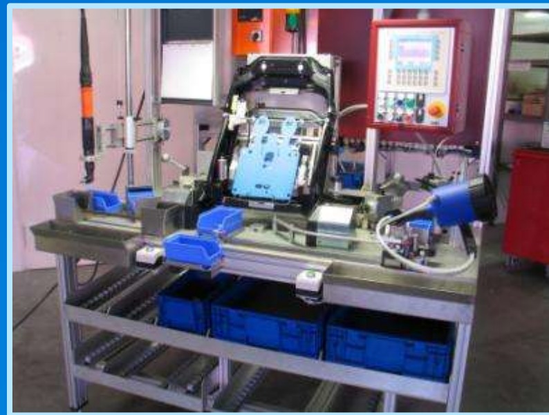
Ruční nýtovací stanoviště - BROSE Nýtování sedačky automobilu, automatická kontrola počtu nýtů
