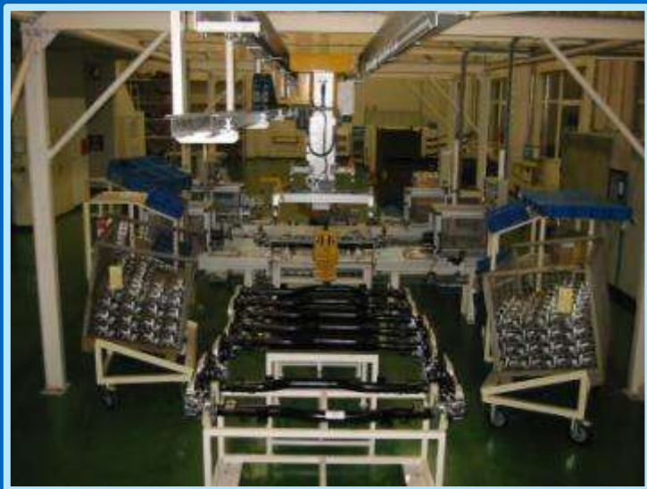
Transportní manipulátor – BENTELER Manipulace s díly , plně automatický systém pro zakládání a skladování palet
