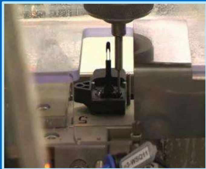
Montáž senzoru- CONTINENTAL Aplikace lepidla, přesné odměření dávky lepidla
