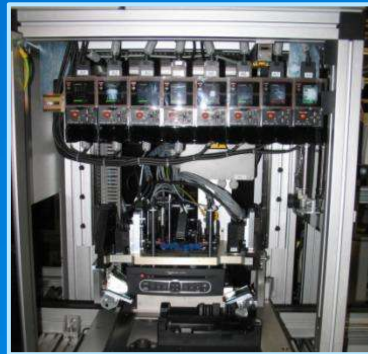
Montážní linka – CONTINENTAL Pracoviště pro montáž rádia, kontrola 8-mi pozic
