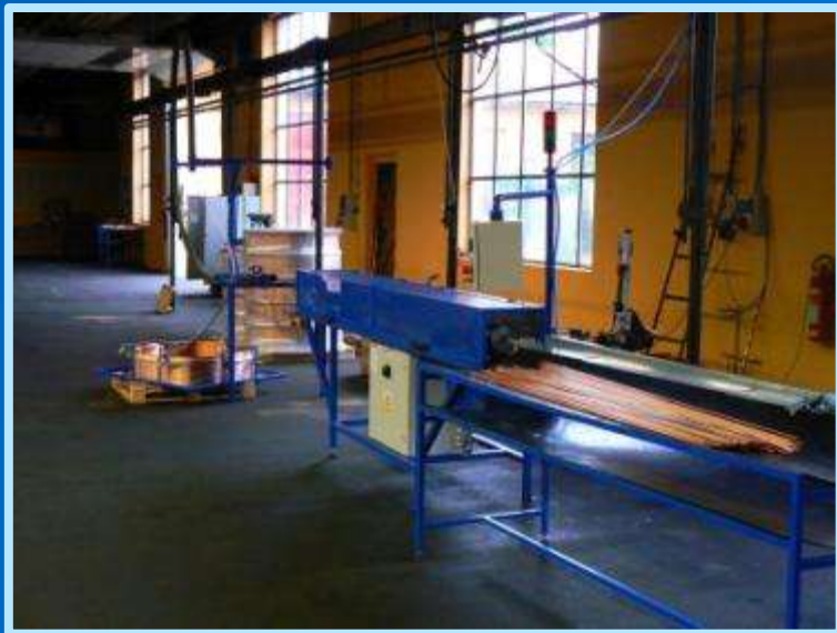
Linka na solární panely – PROPULS SOLAR Rovnění a řezání měděných trubek
