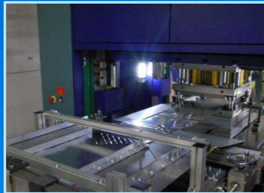
Linka na výměníky - 2VV Dělení a ohýbání plechů
