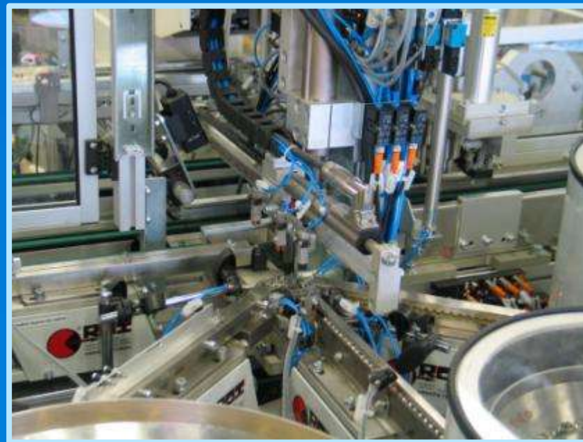
Dvouosý manipulátor – ABB Rychlý dvouosý manipulátor pro zakládání 3 malých dílů, přesnost založení 0.05 mm, rychlost 1.7s
