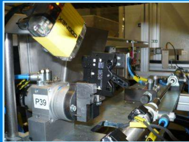
Kamerový systém - CONTINENTAL Identifikace palivového snímače, DMX systém
