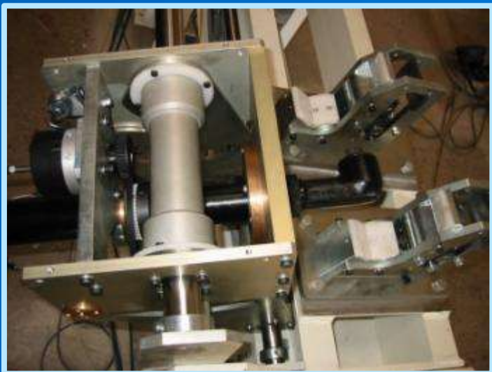
Šroubovací stanoviště – BENTELER Poloautomatické šroubování nápravy automobilu
