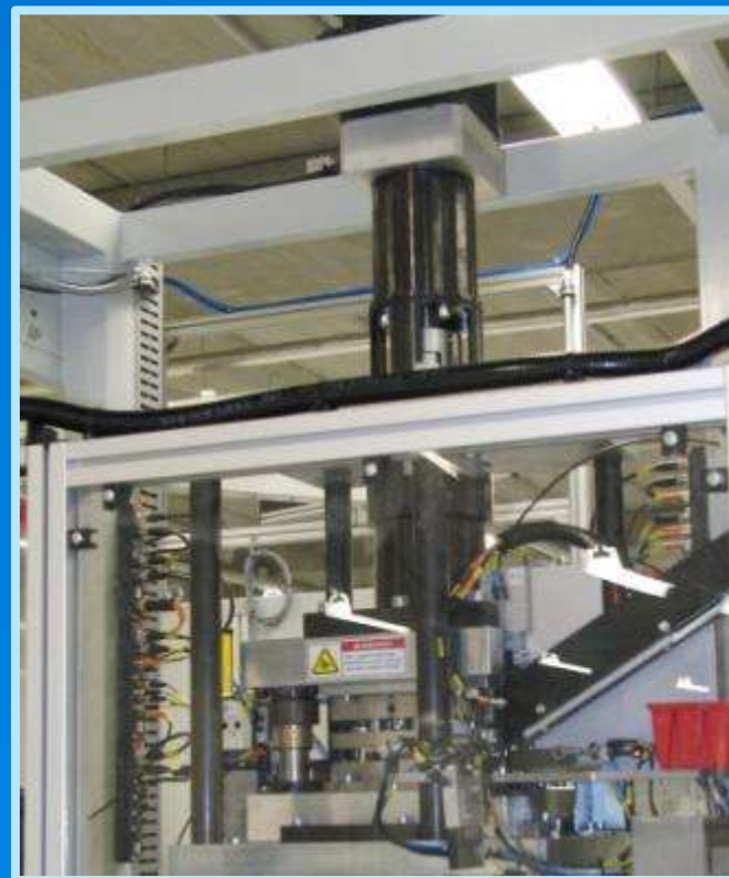
Elektro-lis - CONTINENTAL Lisování pomocí servo pohonu, do 5t
