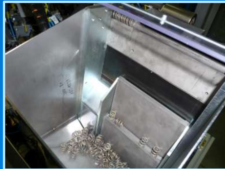
Lineární podavač – ALCO Zásobování výrobní linky lištovým podavačem
