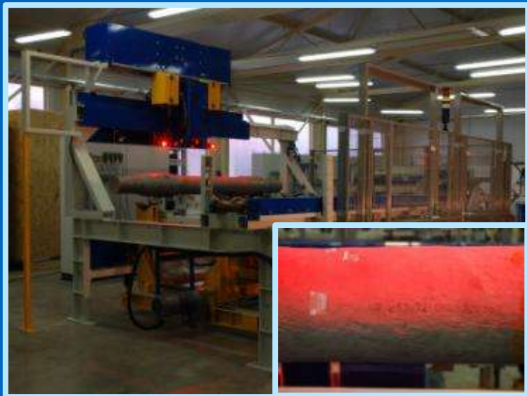
Značící linka – UVZ Niznij Tagil Russia Převod alfa-numerického kódu na DMX kód
