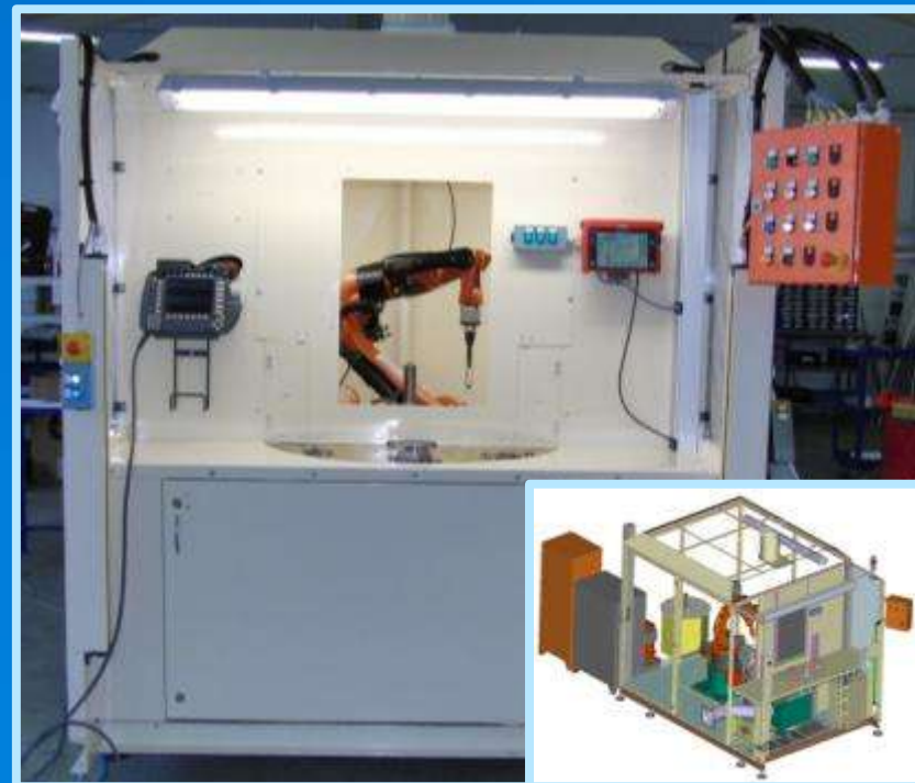
Svařovací buňka - KYB Svařování tlumičů automobilů
