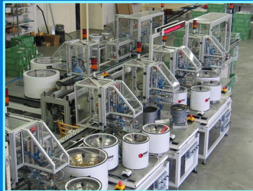
Plně automatická výrobní linka - ABB Montáž domovních spínačů, použití kamerových systémů, takt 2s
