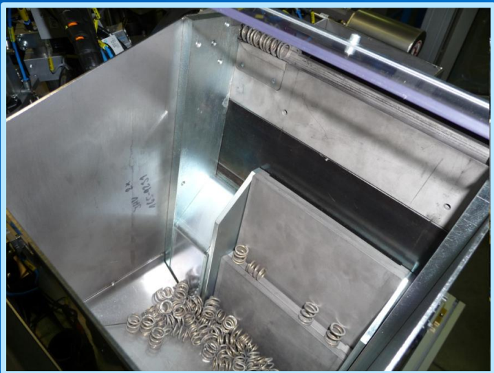
Lištový podavač Nevibrační podávání komponentů, náhrada vibračních zásobníků
