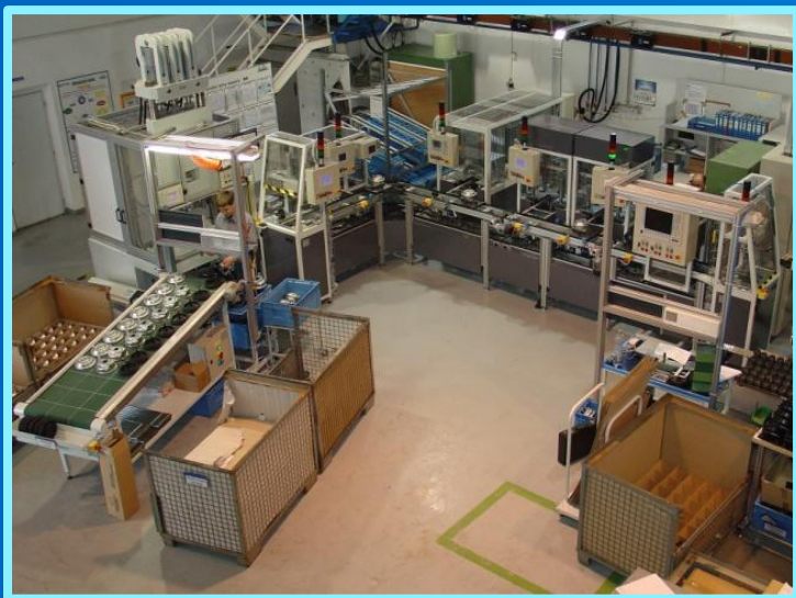
Výrobní linka – KNORR BREMSE Linka na montáž náprav automobilu, včetně řešení paletového hospodářství
